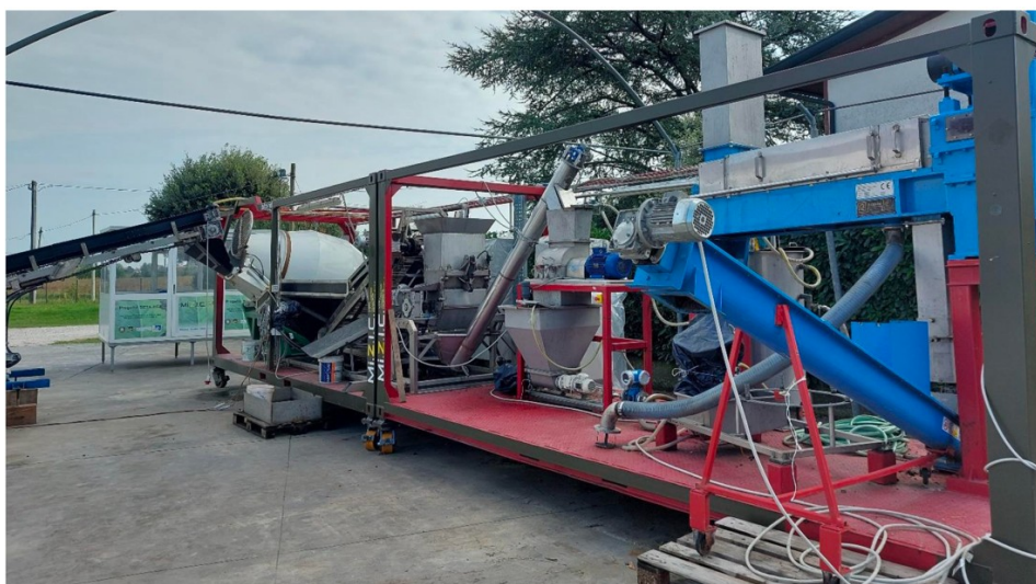
Prototipo linea di lavorazione radici di barbabietola da zucchero
